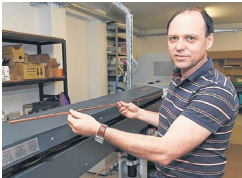
Ausgangsmaterial: Aus solchen Metallstangen werden in computergesteuerten Maschinen die Geschosse geschnitten und gefräst. Entwicklungschef Tobias Büttner (Foto) hat die spezielle Kupferlegierung selbst ausgetüfelt.
