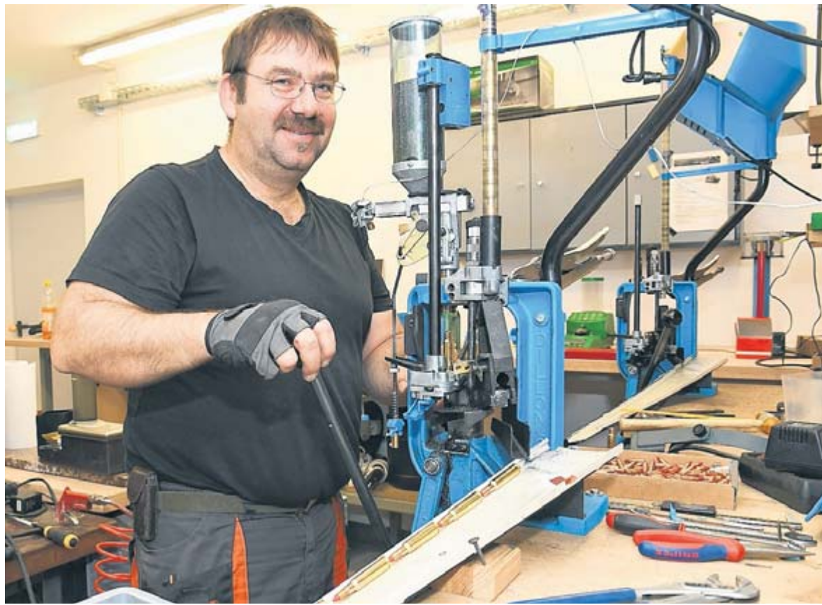
Patronenmanufaktur: In der Sax Munitionsfabrik ist vieles Handarbeit. Hier fügt Mitarbeiter Harald Trzewik Hülse und Geschoss mit einer Ladepresse zusammen. Wegen der großen Nachfrage nach Sax-Munition soll für diese Arbeit demnächst zusätzlich ein Kleinautomat eingesetzt werden.
