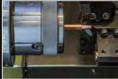
Außenkontur drehen rotating the outer contour
